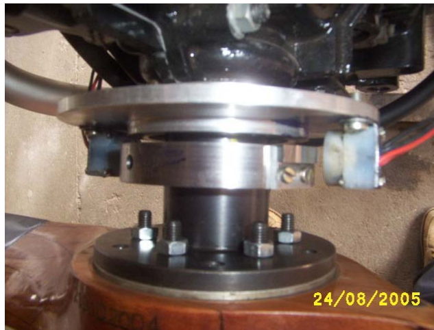
Foto 1 – Exemplo de Dispositivo de Fixação dos Sensores (Cortesia Aerotec – Jundiaí)
