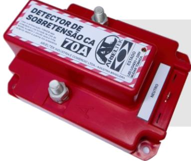
**Detector de Sobretensão CA** tem como finalidade a proteção contra ligações acidentais de barcos 110V na tomada de Cais 220V, quando ligado na linha de maior tensão ele isola a linha protegendo os acessórios, tem capacidade máxima de 70A e LED informativo de tensão errada.
